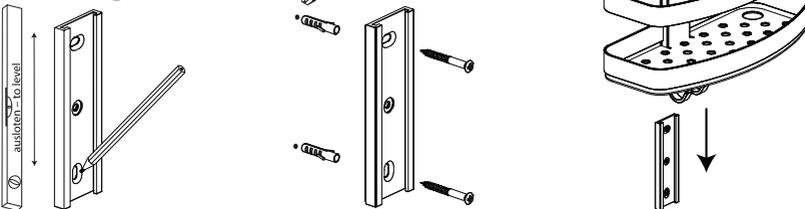
Ausrichten, Bohrlöcher markieren. Bohren und mit beigelegten Dübeln verschrauben. Korb einhängen.
