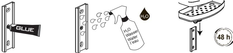
Kleber in mittlere Öffnung des Adapters drücken, bis er aus den anderen Öffnungen austritt. Mit reichlich Wasser besprühen. Korb einhängen. Nach 48 h belastbar. Die Endfestigkeit ist nach ca. 5-7 Tagen erreicht.
