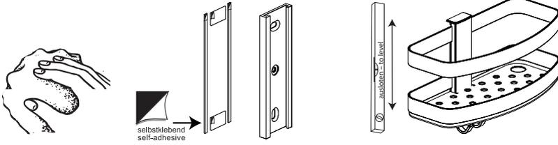
Oberfläche reinigen. Schutzfolie des doppelseitigen Klebebandes entfernen. Klebeadapter mit Korb an der Wand ausrichten und andrücken. Korb aushängen.
